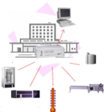
L'interfacciamento di un **sistema di monitoraggio** può importare nel sistema gli allarmi rilevati sugli item (server, impianti di rete, impianti di controllo ambientale quali antincendio o condizionamento) e renderli disponibili per analisi incrociate sui dati
