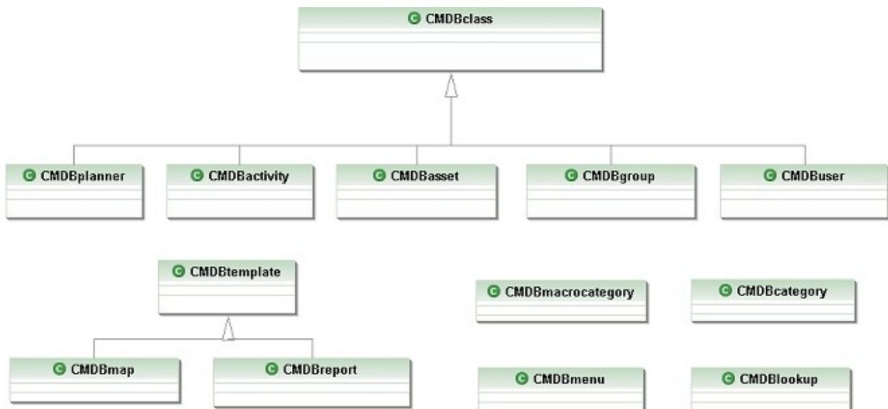
Il diagramma UML delle classi java delegate alla generazione delle schede di CMDBuild per l'editing dei dati è il seguente:
